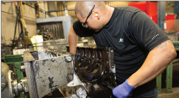
Cada núcleo de motor se desmonta por completo.
